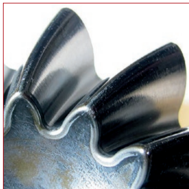
Bild 6: Rotor nach 1500 Stunden Probelauf; Nahaufnahme (Bosch/Gardner Denver)
